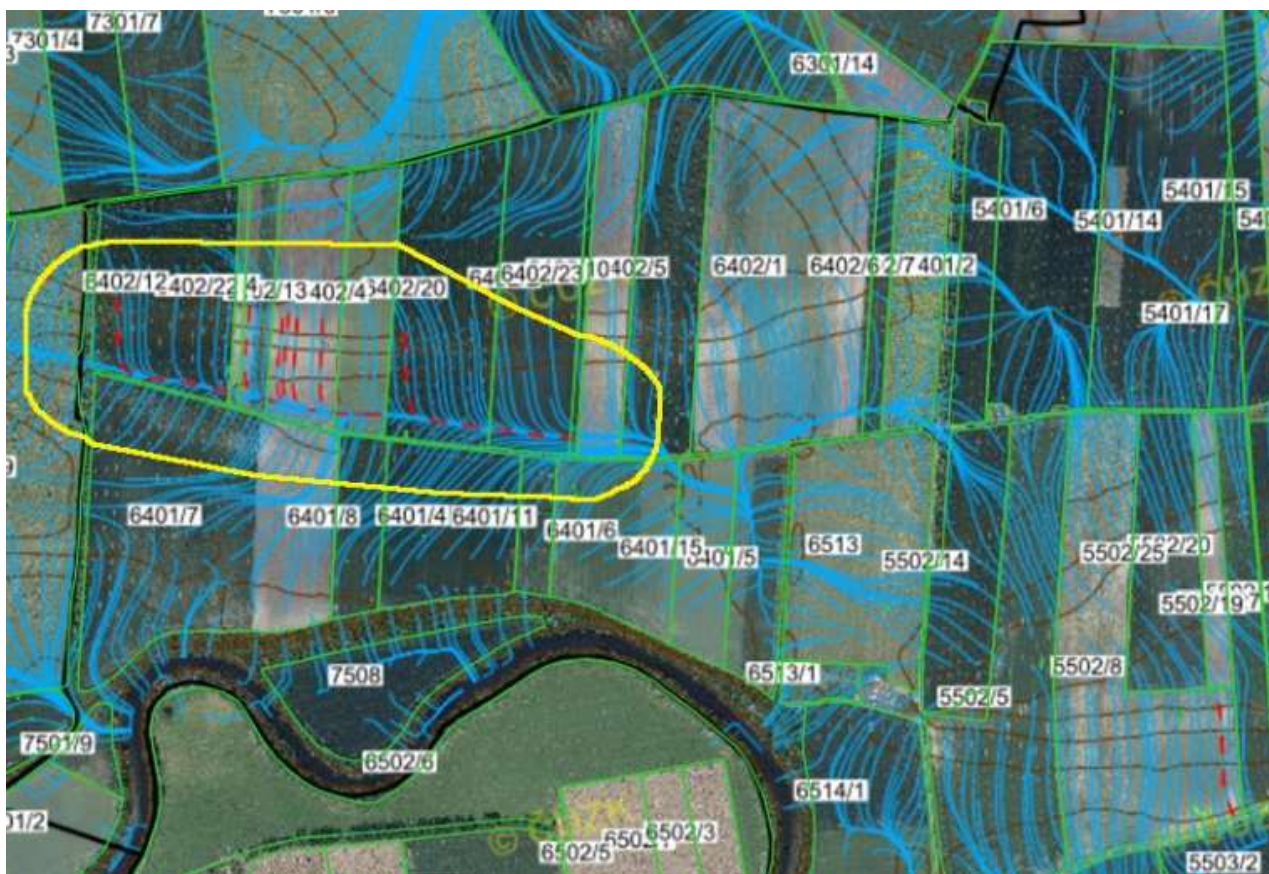
Červeně zvýrazněné dráhy soustředěného odtoku vody na svažitéch pozemcích nad odvodňovacím kanálem
